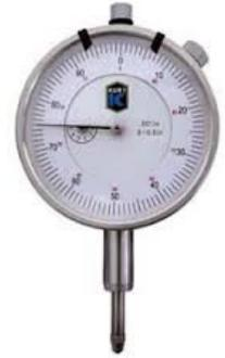
La aplicación, uso y manejo de estos instrumentos, se encuentra ligada a la clase de exactitud que se desea alcanzar o detectar, es por eso, que lo más común es encontrar en el mercado instrumentos con resolución de 0,01 mm y 0,001 mm.
