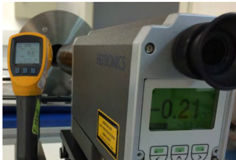
Calibración por transferencia: Termómetro infrarrojo bajo calibración Vs. Termómetro infrarrojo patrón
