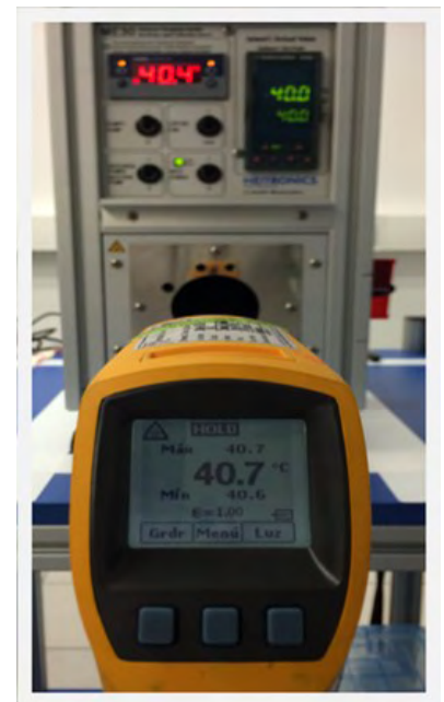
Calibración Termómetro infrarrojo bajo calibración Vs. radiador calibrado radiométricamente
