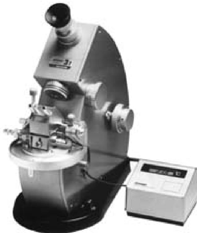
Figura 3. Refractómetro tipo ABBE.
