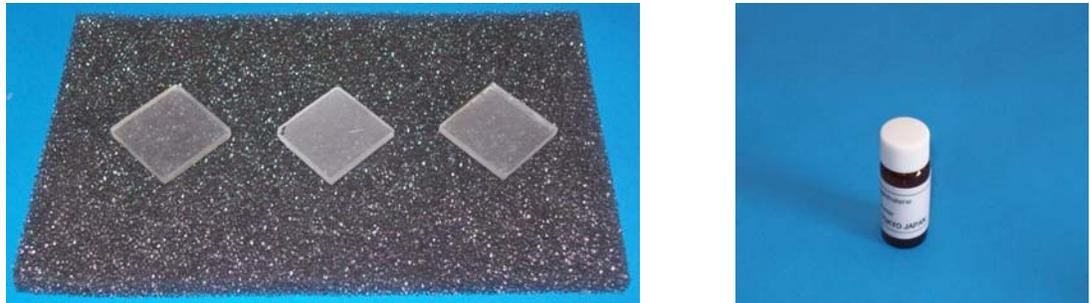
Figura 8. Foto de los cristales de índice de refracción y líquidos.
