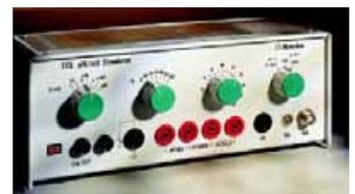
Fig. 9. Simulador eléctrico de pH (mV).
