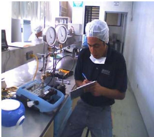
Cuando se realizan trabajos fuera del laboratorio (calibración o prueba "in-situ"), es muy importante que el personal que realice la calibración o prueba, cuente con equipo para monitorear, medir y registrar las condiciones ambientales y u o otras magnitudes de influencia durante el proceso de la calibración o prueba, ya que esto será muy importante para poder realizar las correcciones adecuadas para dicha calibración o prueba.
