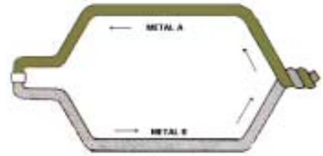
El coeficiente Seebeck ( $S$ ) se define como la derivada de dicha tensión ( $E$ ) con respecto a la temperatura ( $T$ ):  $S = \frac{dE}{dT}$
