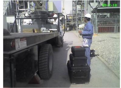
Los patrones de referencia deben mantenerse en un entorno adecuado todo el tiempo, de manera que la manipulación, transporte y almacenamiento no invalide su estado de calibración.
